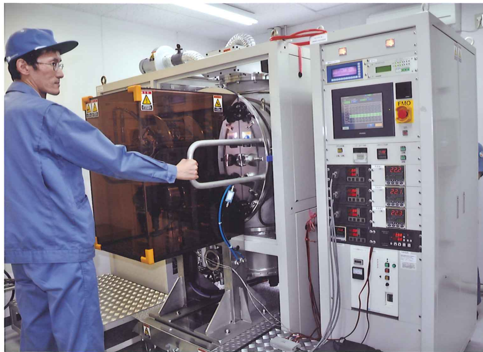
「TIERコート」を金型に加工するための有機薄膜形成抵抗蒸着装置。東亜電化では2011年度から本格的に、TIERコートの受注を開始。コンスタントに加工処理依頼や問い合わせがあるという＝盛岡市玉山区の東亜電化工場内
